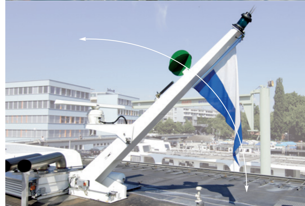
Hauptmast beim Absenken
