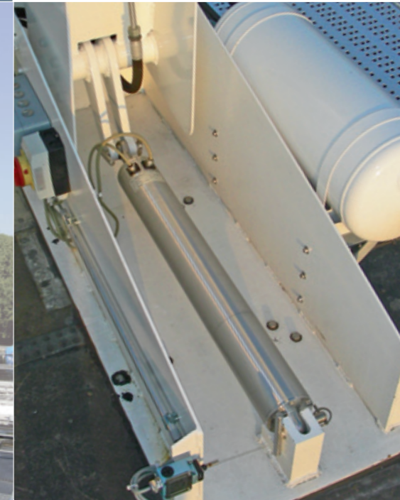
Linearantrieb in Betriebsposition «Masten oben»
