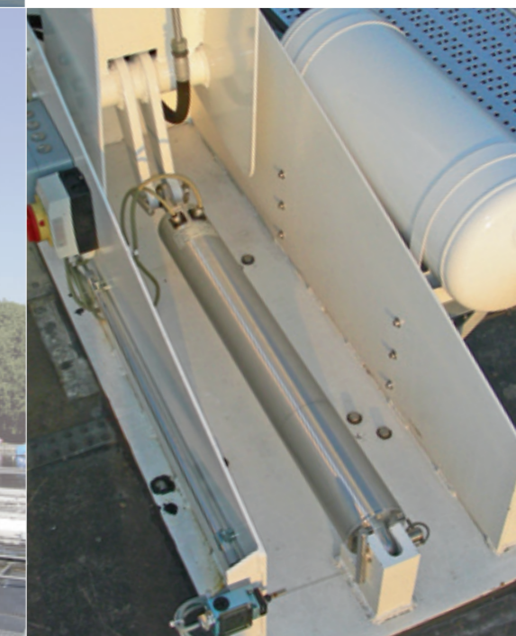
Attuatore lineare con posizione « albero im alto »
