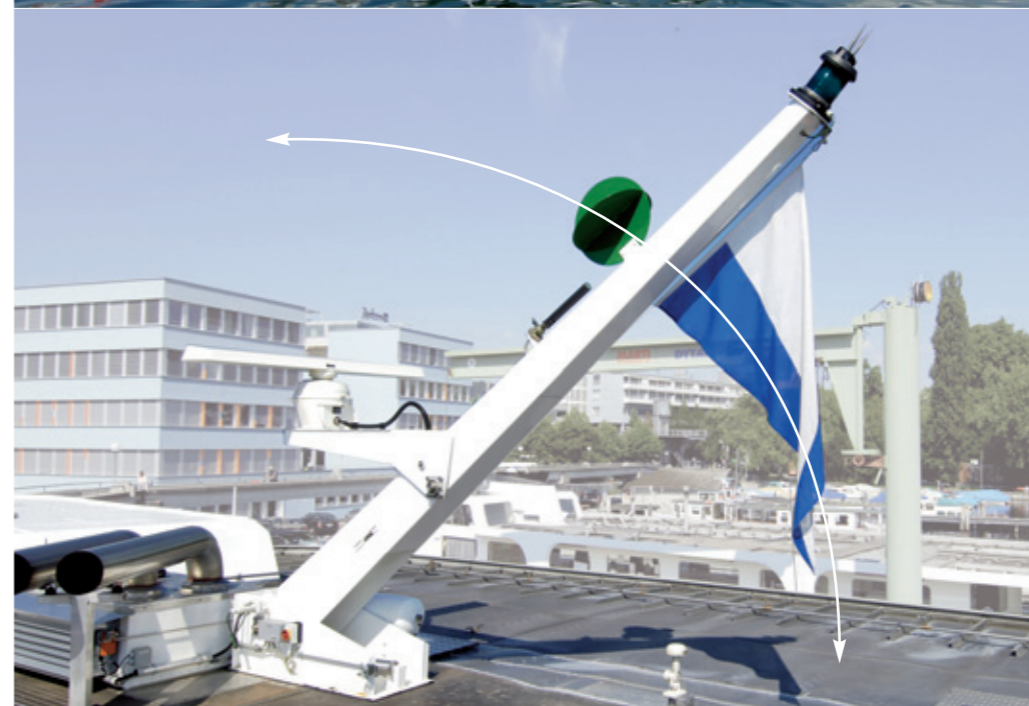
L'albero maestro durante l'abbassamento
